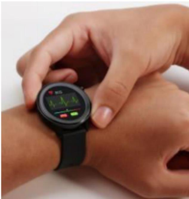
**i** Der verbaute EKG-Sensor von Texas Instruments ist nach Medizinsicherheitsnorm geprüft und verwendet geringe Strommengen von lediglich 350 Mikrowatt. Dadurch ist die Verwendung des EKG auch für Träger von Herzschrittmachern ungefährlich. Ein Herzschrittmacher kann jedoch die Messergebnisse beeinflussen – die Erkennung von etwaigen Herzerkrankungen ist daher möglicherweise nicht korrekt und das Diagramm sollte jedenfalls mit einem Kardiologen besprochen werden!
